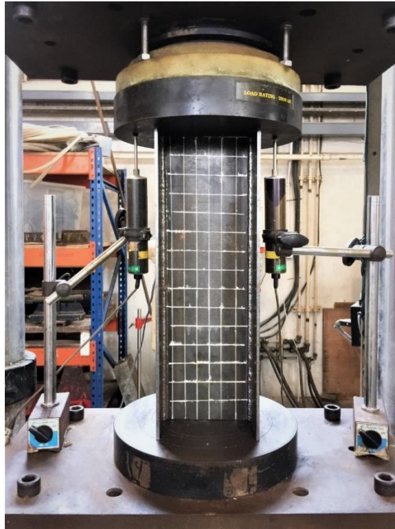
Fig. 11. Stub column test rig.
